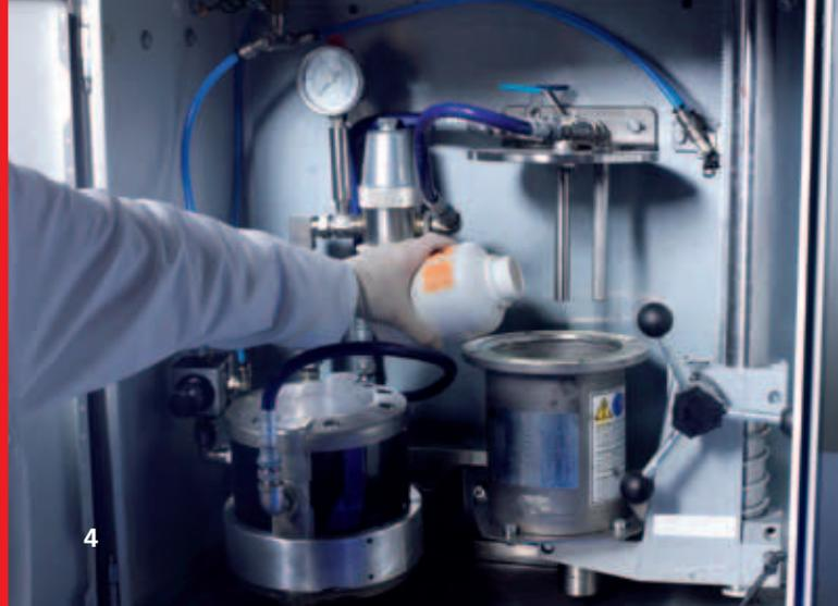
belastet wird wie später im praktischen Betrieb. Durch diese kreisförmige Testanlage kann das Lacksystem kontinuierlich bzw. im Stich gefahren werden. Eine Temperierung der Ringleitung ist bis 40 °Celsius möglich.
