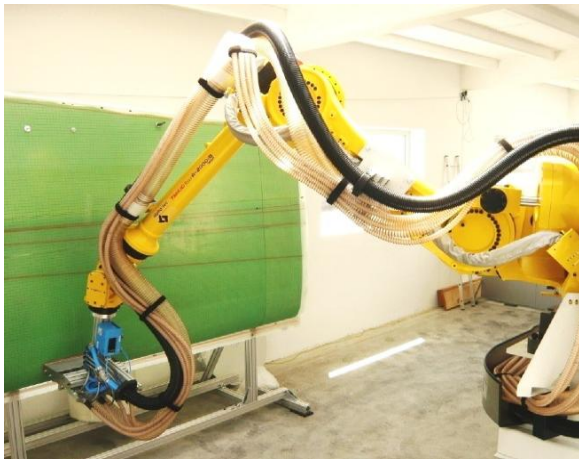
Robotergeführter Vakuum-Saugstrahlkopf für die Bearbeitung ebener Flächen (Foto: GPI)
