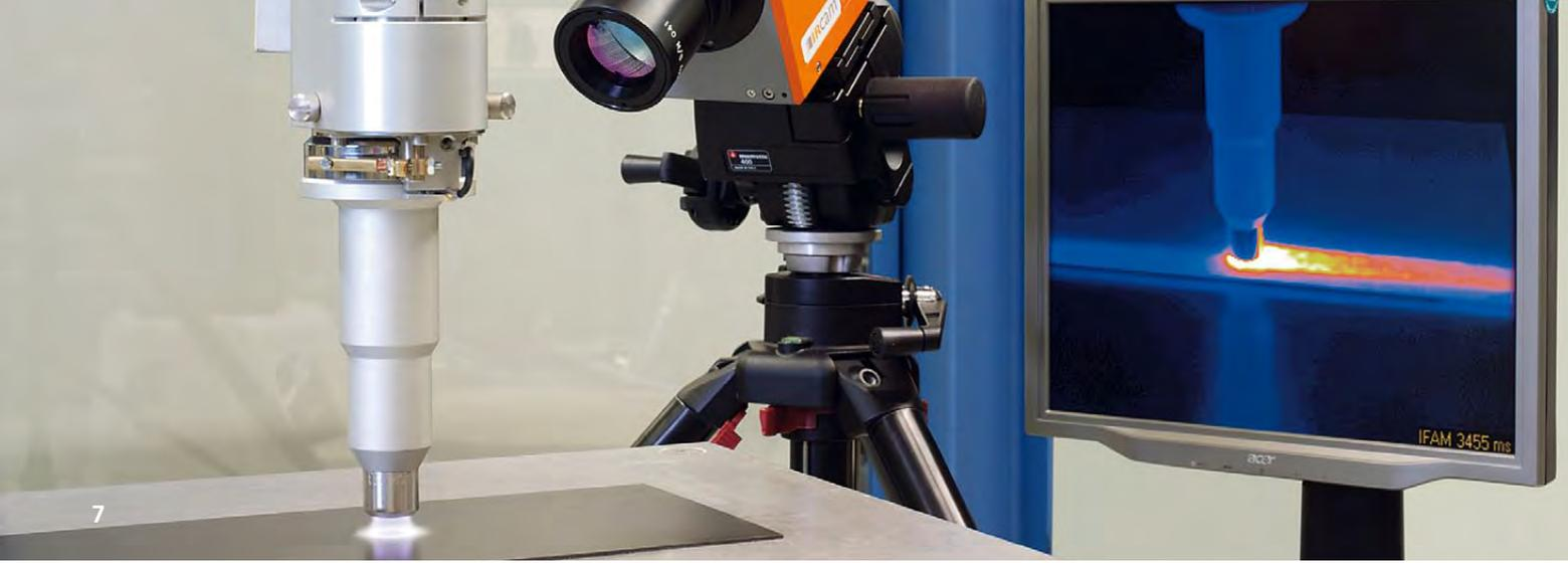
wurde nachgewiesen, dass dieses Verfahren manuelle Aktivierungen bestens ersetzen kann. PLATO untersuchte verschiedene CFK-Oberflächen und behandelte sie mit AD-Plasma vor, bezog unterschiedliche Entformungsprozesse und damit verschiedenartige Kontaminationen in die Untersuchung ein und zeigte, dass mit dieser Vorbehandlung langzeitbeständige Klebungen im Flugzeugbau möglich sind. Die Klebungen wurden auf ihre Alterungsbeständigkeit überprüft – mit ausgezeichneten Ergebnissen.
