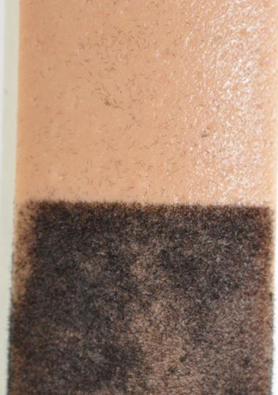
Es entsteht eine dünne siliziumanorganische Schicht. Die Oberflächen werden glatter und härter und sind durch neue Eigenschaften geprägt:
