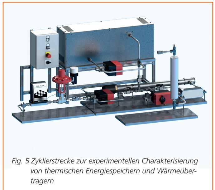
Fig. 5 Zyklierstrecke zur experimentellen Charakterisierung von thermischen Energiespeichern und Wärmeübertragern
