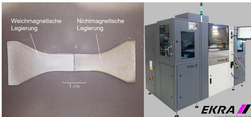
Teststruktur eines im Siebdruckverfahren hergestellten Hybridmaterials, bestehend aus einer weichmagnetischen Legierung und einer nichtmagnetischen Legierung (links). Siebdruckanlage der EKRA Automatisierungstechnik GmbH am Fraunhofer IFAM Dresden, die für die Herstellung der hybriden Strukturen genutzt wurde (rechts).
