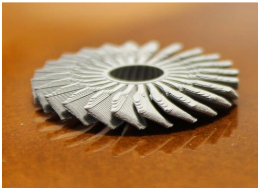
Gedrucktes Flügelrad aus Edelstahl © Fraunhofer IFAM Dresden
