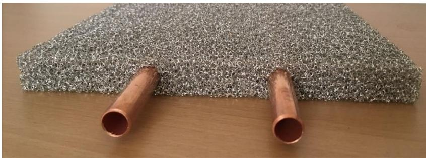
*Zellulare Struktur mit integriertem Wärmeträgerrohr als Grundlage für die Optimierung der Oberflächentemperaturverteilung*
