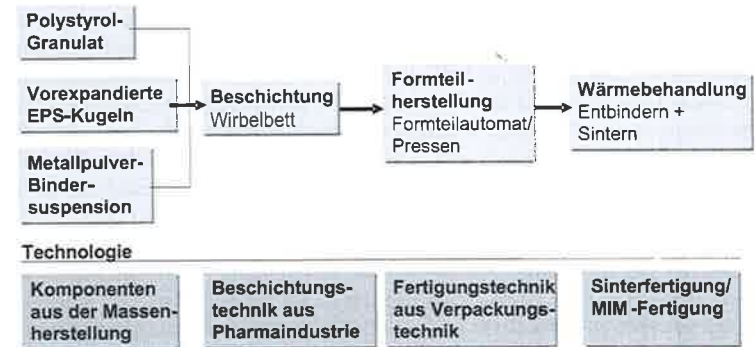
Bild 2: Jeder Herstellungsschritt der Fertigungskette von Hohlkugelstrukturen hat seinen Ursprung in Massenerstellungstechnologien. Dies ist die Grundlage für die Serientauglichkeit des Herstellungsverfahrens.
