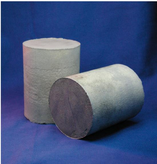
**Bild 2. Mittels „Spark Plasma Sintering“ (SPS) kompaktierte Bolzen einer verdühten Aluminium-Legierung (Durchmesser: 75 mm, Höhe: 85 mm, nahezu 100% theoretische Dichte)**
