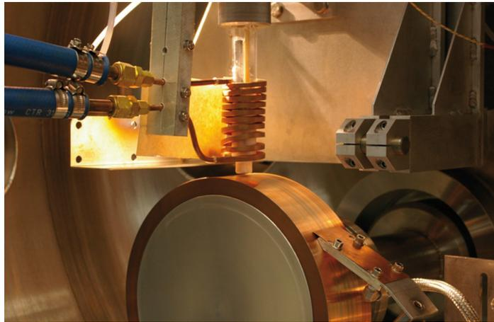
**Bild 1. „Melt Spinning“-Anlage zur Erzeugung metallischer Werkstoffe mit homogenen Eigenschaften**
