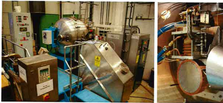
Bild 6: Außen- und Innenansicht der Rascherstarrungsanlage mit Rezipient, HF-Generator und Steuerung am IFAM-Dresden
