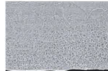
Bild 7: REM-Aufnahme vom Querschnitt des gesponnenen Magnesium-Bandes der Mg_{97,9}Ni_{2,1} -Legierung
