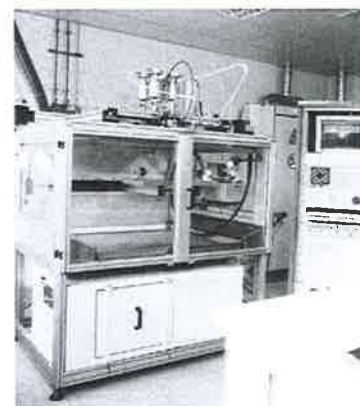
Bild 29: Nasspulversprühanlage am IFAM.
