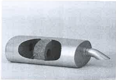
Bild 36: Hohlkugelstrukturen in einem prototypischen Fahrzeug-Schalldämpfer [EMCON Technologies].
