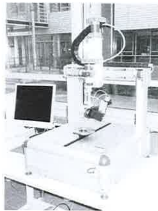
Bild 34: 4-Achsen-Dosierroboter am IFAM, frei programmierbar in x-, y- und z-Richtung sowie in einer Rotationsachse.
