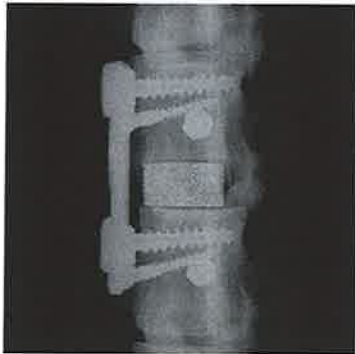
Bild 38: Einsatz von offenzelligen metallischen Schäumen als Wirbelkörperimplantat. (Quelle: TU Dresden)
