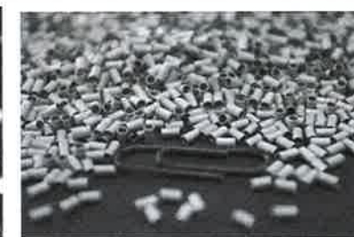
Bild 16: Siebgedruckte Stahlhülsen. Auf der Laboranlage des IFAM können davon bis zu 3000 Teile gleichzeitig gedruckt werden.
