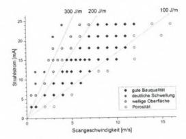
Bild 6: Prozessfenster Ti-6Al-4V
