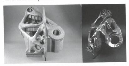
Bild 16: Main Gearbox Bracket im "as-built" (links) und endbearbeitetem Zustand (rechts)
