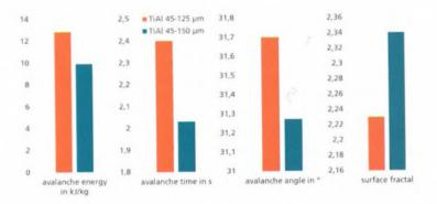
**Bild 2:** Darstellung von Pulverparametern resultierend aus der dynamischen Lawinenmessung mit dem Revolution Powder Analyser für zwei TiAl-Pulverfraktionen:  $45-125~\mu m$  und  $45-150~\mu m$
