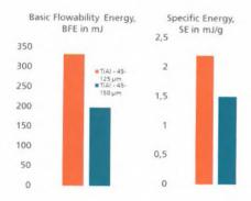
Bild 3: BFE- und SE-Werte gemessen mit dem FT4 Freeman-Rheometer für zwei TiAl-Fraktionen:  $45-125~\mu m$  und  $45-150~\mu m$
