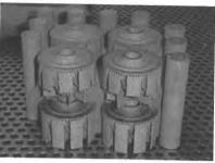
Bild 17: Demonstratoren aus TiAl (RNT 650): einzeln, mit und ohne Stützstrukturen (links), gestapelt (2 Lagen) mit Stützstrukturen (rechts)
