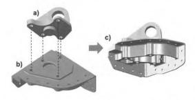
Bild 12: a) Upper Bracket, b) Counter Bracket und das c) Main Gearbox Bracket
