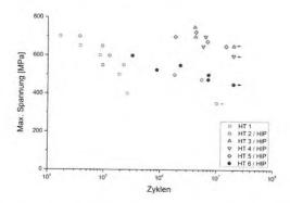
**Bild 8:** Ermüdungsverhalten der wärmebehandelten Ti-6Al-4V-EBM-Proben. Datenpunkte mit Pfeilen markieren Durchläufer
