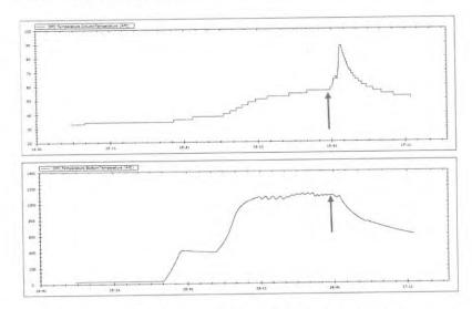
Bild 9: Temperaturen  $T_C$  (oben) und  $T_S$  (unten) für Baujob mit frühem "smoke"
