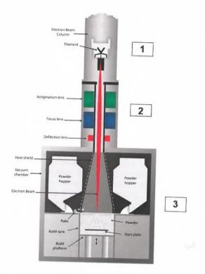
Bild 1: Aufbau einer EBM-Anlage [1]
