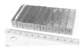
Bild 4: Probenserie EBM (Werkstoff Ti-6Al-4V)
