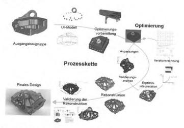
Bild 13: Prozesskette des Optimierungsproblems
