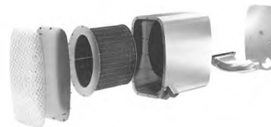
Bild 16: Partikelfilter für Lkw. Reduzierung der Rußpartikelemissionen auf Euro IV Standard
