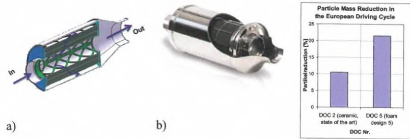
Bild 11: Alantum Dieseloxydationskatalysator (DOC) basierend auf Metallschaum, optimiert für die Partikelfiltration (a) Schematische Darstellung des Radialfilters, (b) Fotografie des katalysierten Partikelfilters
